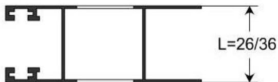
**Pour les vantaux d'une largeur de 26mm à 36mm**
